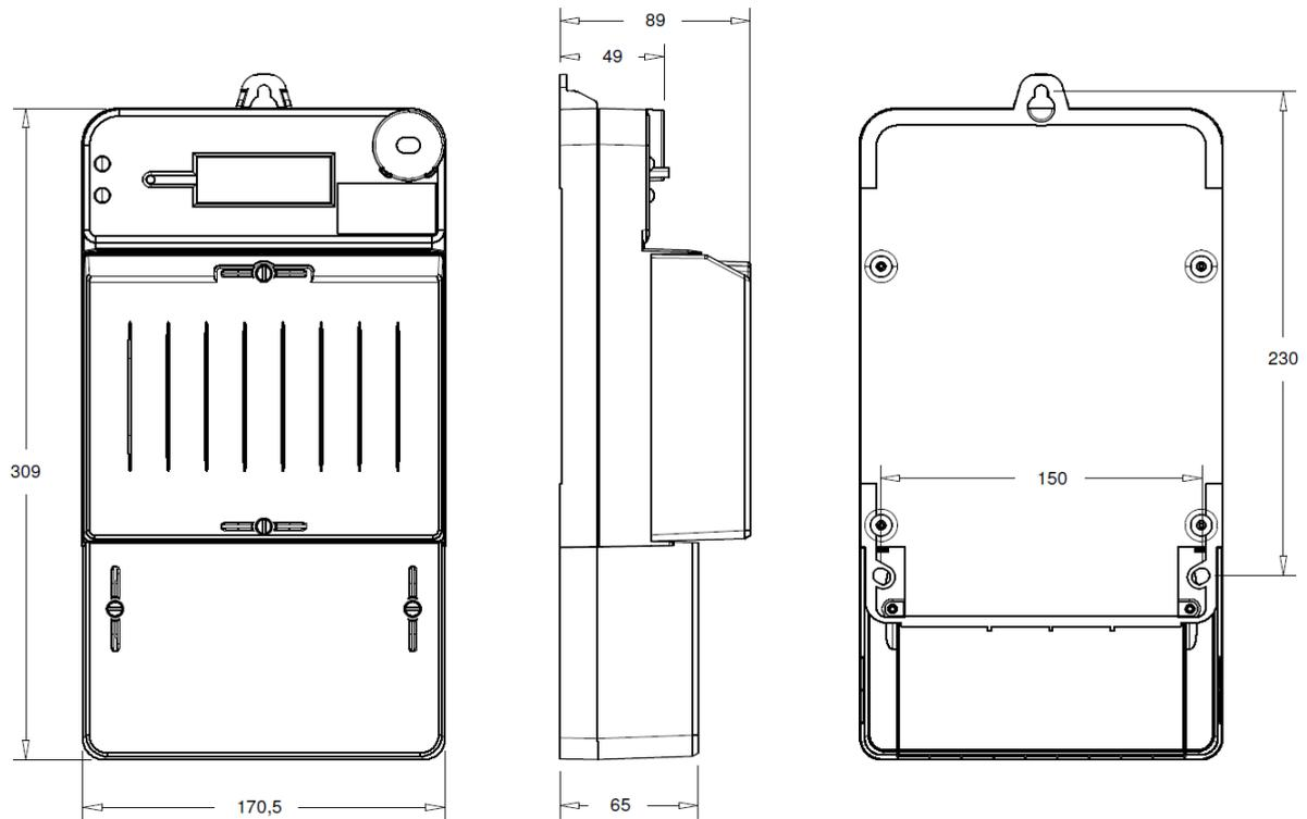
**Abb. 12: Abmessungen des Zählers, Ansicht vorne, seitlich und Rückseite**
