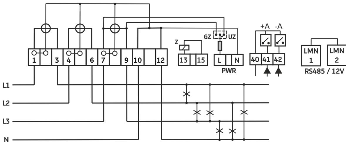
Abb. 13: Anschlussplan für den Zähler
