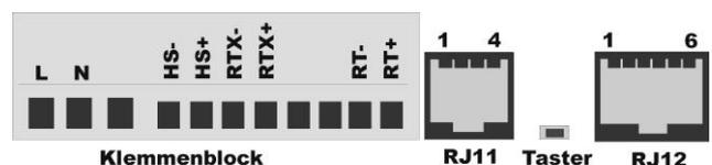
Das Gerät verfügt über 3 verschiedene Zählerschnittstellen. Es kann davon immer nur eine genutzt werden.
