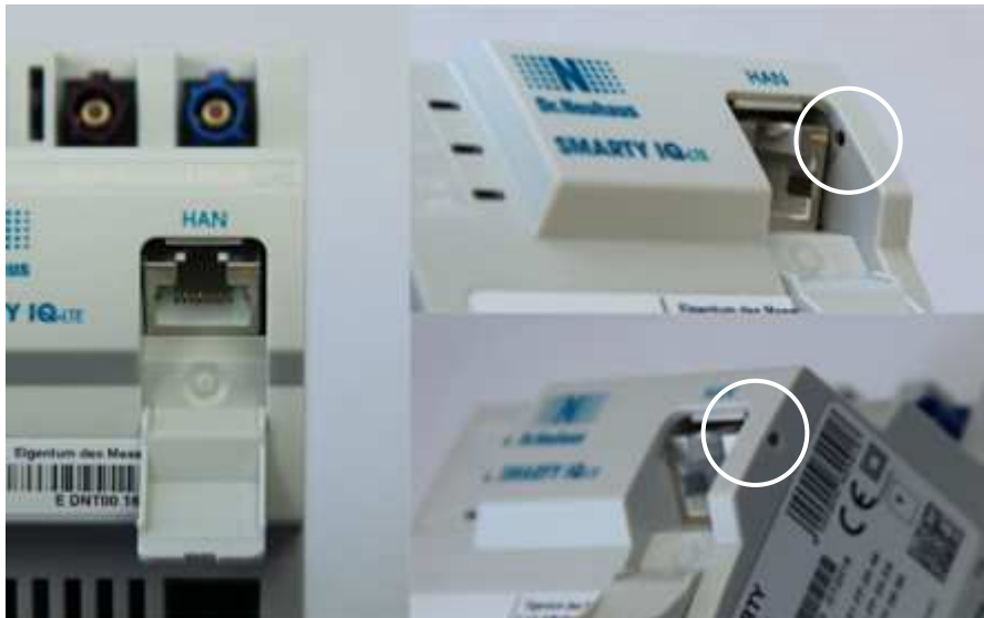
Bild 5 Plombierstelle für nationales Prüfkenzeichen.
